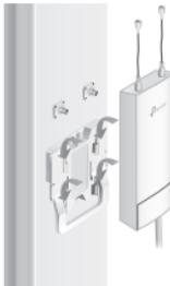
착 브래킷을 사용하여 장치를 안테나에 장착하십시오. 장치의 RF 케이블을 안테나의 해당 커넥터에 연결하십시오. 보호 캡을 부착하십시오.
